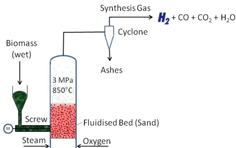
Fig. 7 Hydrogen Production
